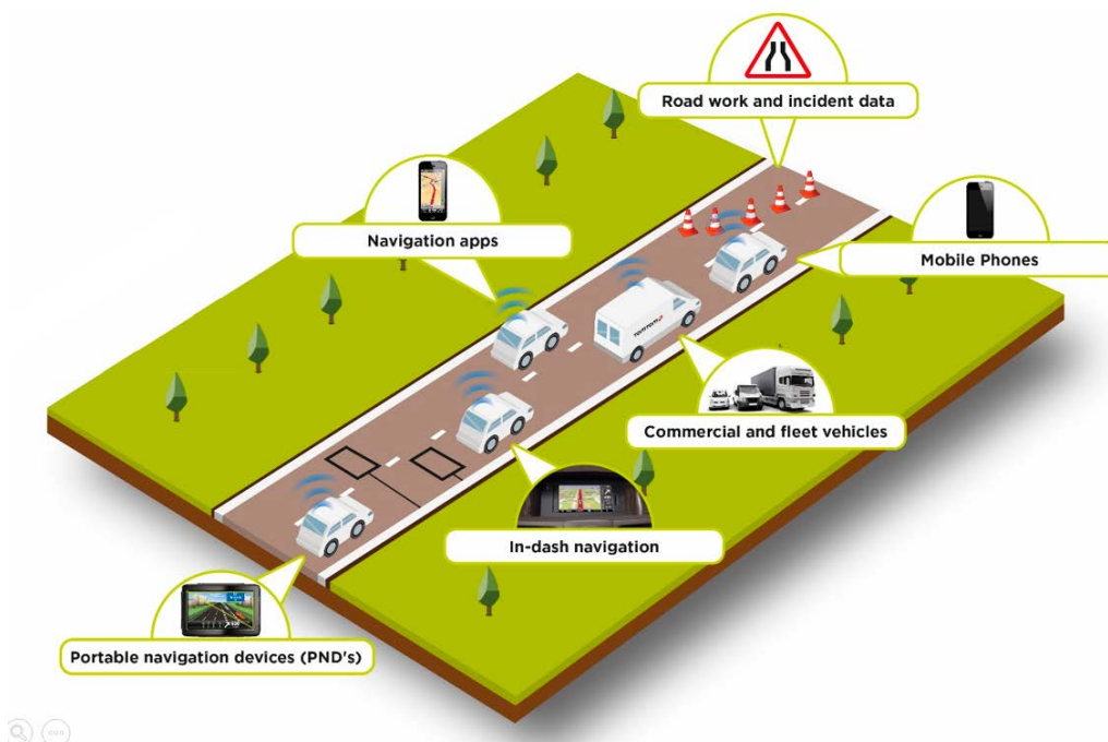
Figuur 3.1 Illustratie van mobiele data en vaste data (verkeersdetectielus in het wegdek). Bron: TomTom.
